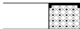
TREGRAPH® AR пръстен с армировка от стоманена нишка SS 304 и бандажиран по едното чело с лист от AISI 316
